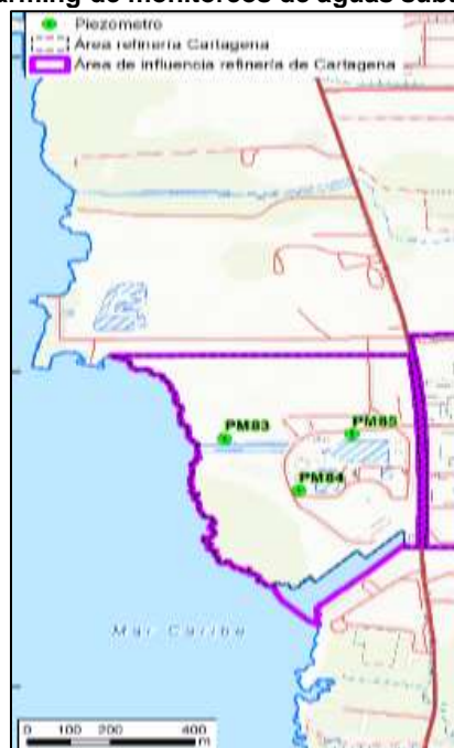
Figura 8.1 Red de piezómetros para el área de landFarming de monitoreos de aguas subterráneas de la Refinería de Cartagena
